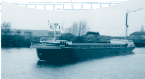
'M.S. Arie Jacob' van P.J. de Waardt. Capaciteit: 90 TEU (45 vrachtwagens). Met dank aan Theo Bakkers, KSV Schuttevaer.
